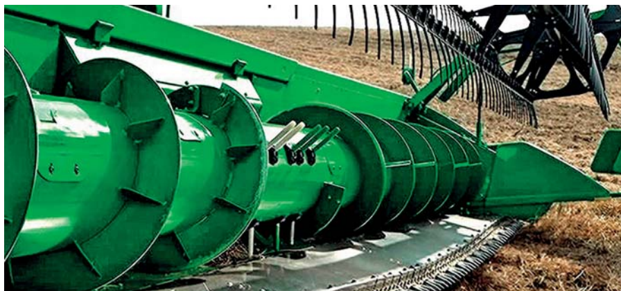
Фото 1. Режущий аппарат HydraFlex сокращает потери до 3 ц/га
